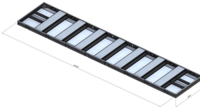
Figura 11 - Forma de alumínio canto interno 500x2400mm
