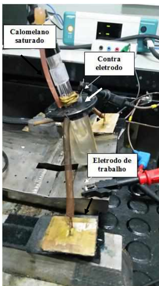
Figura 3.7 – Sistema de fixação ao eletrodo de trabalho da célula portátil para realização do ensaio de PERC.
