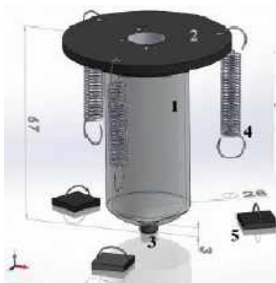
Figura 2.21 – Desenho esquemático de projeto da célula portátil. 1- Corpo da célula, 2-Tampa, 3- O'ring, 4- Molas de fixação, 5- Pés contendo velcros. Medidas em mm (ENNES, 2013).
