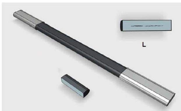
**Figura 28: Esquema 3D de uma amostra e a seção longitudinal de um corte.**
