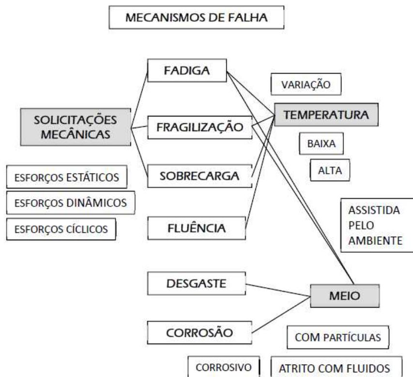
Figura 15: Resumo dos mecanismos de falhas, associados às aplicações (ZEEMANN *et al.* 2010)
