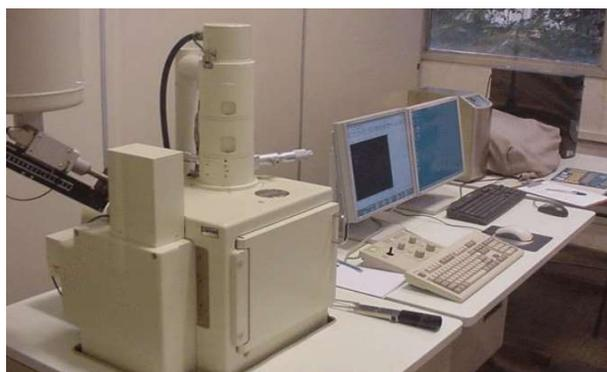
**Figura 37:** Microscópio eletrônico de varredura (MEV) JEOL JSM-6460LV
