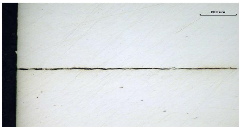
**Figura 45: Inspeção metalográfica amostra CD10x5-1-3 corte longitudinal região tensionada**
