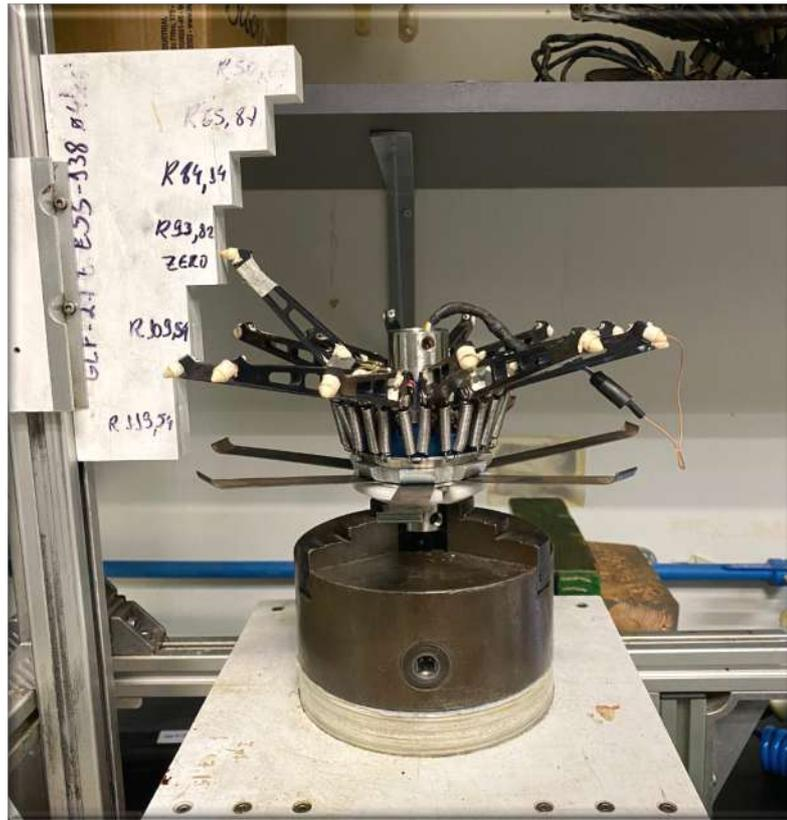
Figura 2.7: PIG Palito em calibração na bancada.
