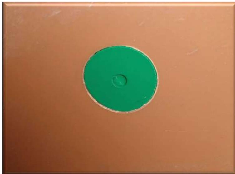
Figura 3.9: Descontinuidades sintética faceando o interior do tubo de PVC.
