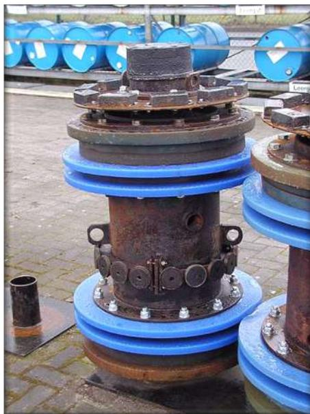
Figura 1.1: PIG de limpeza de 28" de diâmetro.
