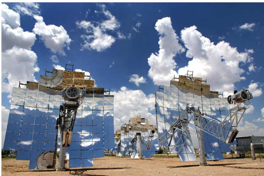
Figura 9 – Concentrador solar do tipo disco parabólico com vários refletores
