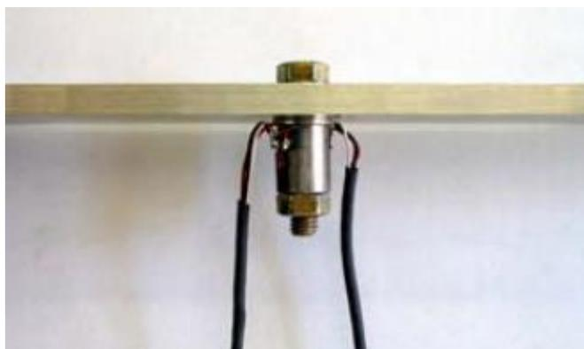
Figura 2.12: Bucha montada na chapa de alumínio
