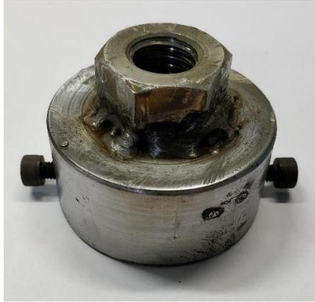
Figura 3.19: Chave para Calibração de torque da célula de 3/4"
