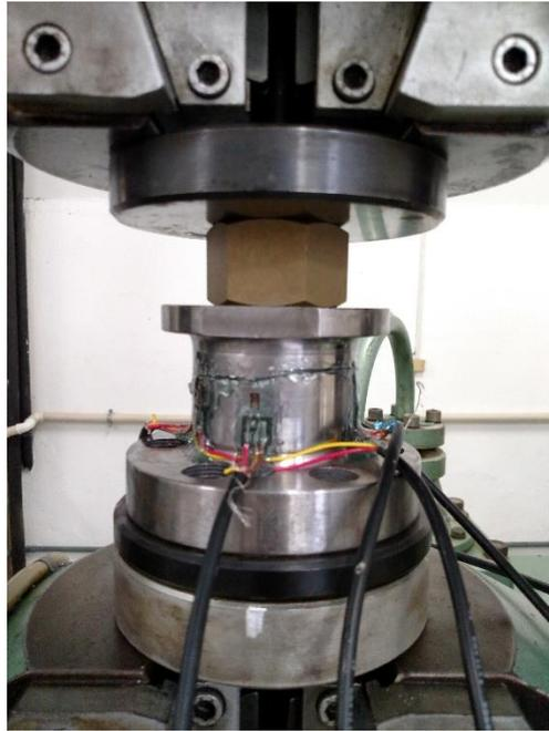
Figura 3.15: Ensaio de compressão com utilização de porca
