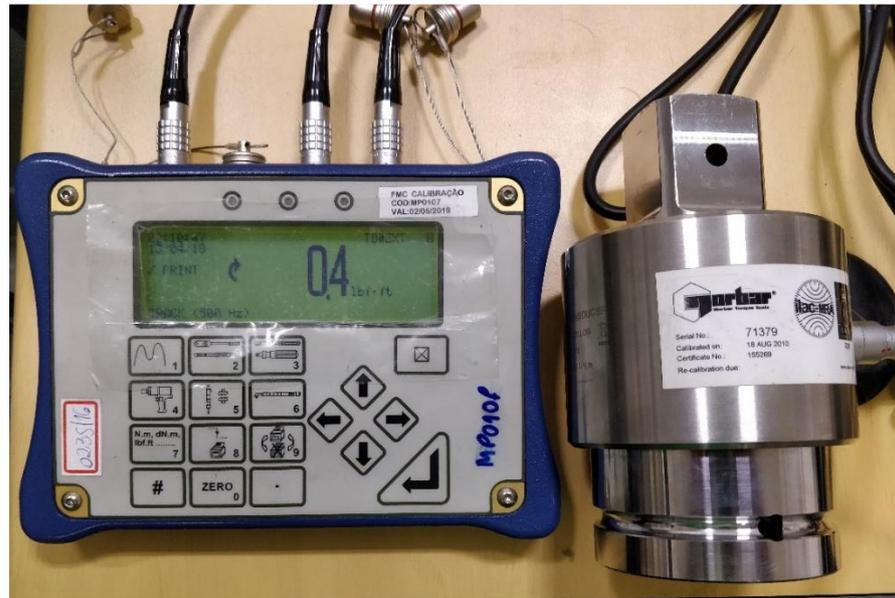
Figura 3.34: Transdutor de torque e interface com mostrador digital
