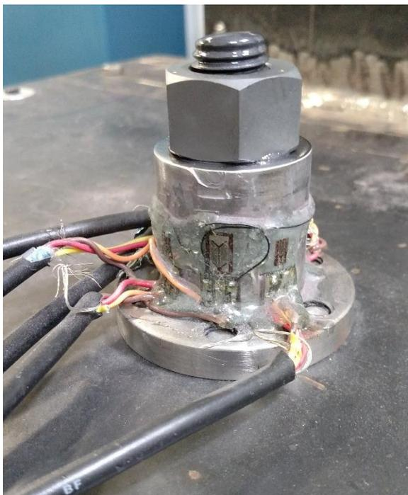
Figura 3.32: Montagem dos fixadores de MoS<sub>2</sub> de 3/4" com lubrificante na célula de carga (*Adaptado de Próprio autor; 2018*).
