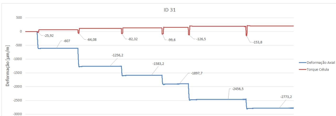
Figura 4.7: Exemplo de gráfico da aplicação de torque em função do tempo no estojo de Cádmio com graxa de 1.1/2'' (ID 31) (Adaptado de Próprio autor; 2018).
