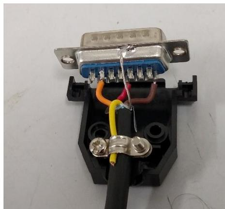
Figura 3.11: Soldagem do cabo elétrico no conector 15 pinos
