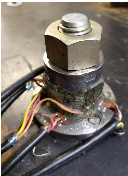
Figura 3.25: Montagem dos fixadores de cádmio sem lubrificante na célula de 3/4"
