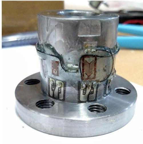
Figura 3.10: Exemplo da soldagem dos terminais dos extensômetros
