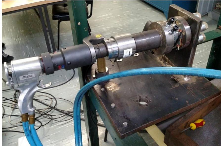
Figura 3.23: Calibração de torque da célula de 1.1/2"
