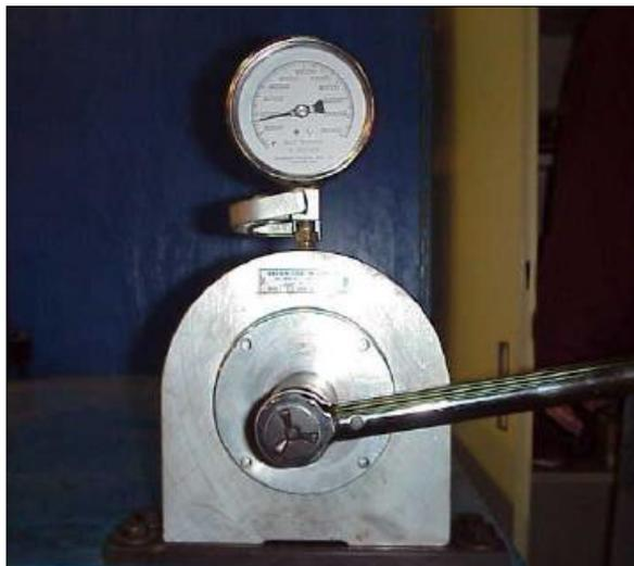
Figura 2.5: Aparato experimental para medição de torque e pré-carga utilizado por Cooper & Heartwell (2011)
