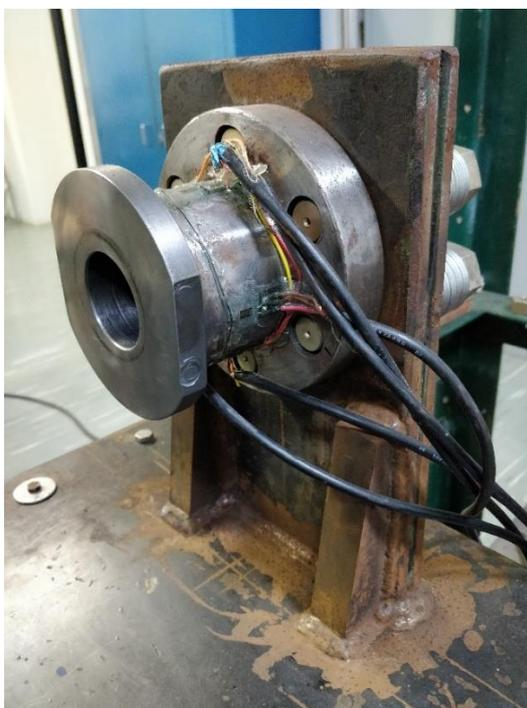
Figura 3.33: Célula de Carga de 1.1/2" fixada à bancada (*Adaptado* de Próprio autor; 2018).
