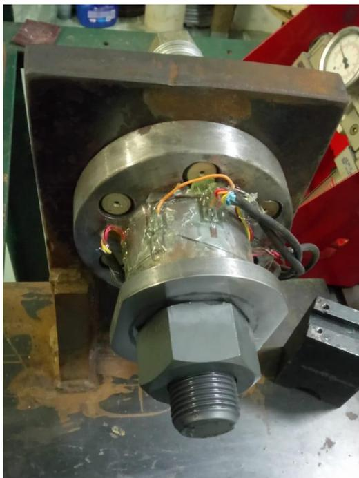
Figura 3.44: Estojo de MoS<sub>2</sub> lubrificado montado na célula de carga (*Adaptado de Próprio autor; 2018*).
