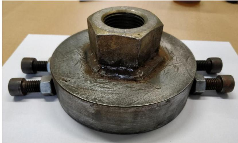
Figura 3.20: Chave para Calibração de torque da célula de 1.1/2"
