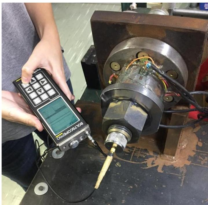
Figura 3.43: Medição do alongamento do estojo com ultrassom entre cada aplicação de torque (*Adaptado de Próprio autor; 2018*).
