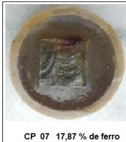
Figura 5.23 – Foto CP 07: corrosão por frestas à temperatura ambiente
