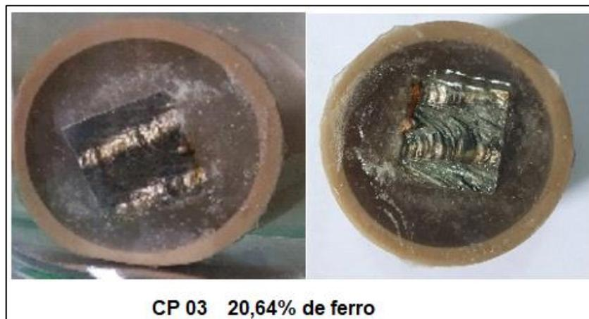
Figura 5.13 – Fotos CP 03: corrosão à temperatura ambiente
