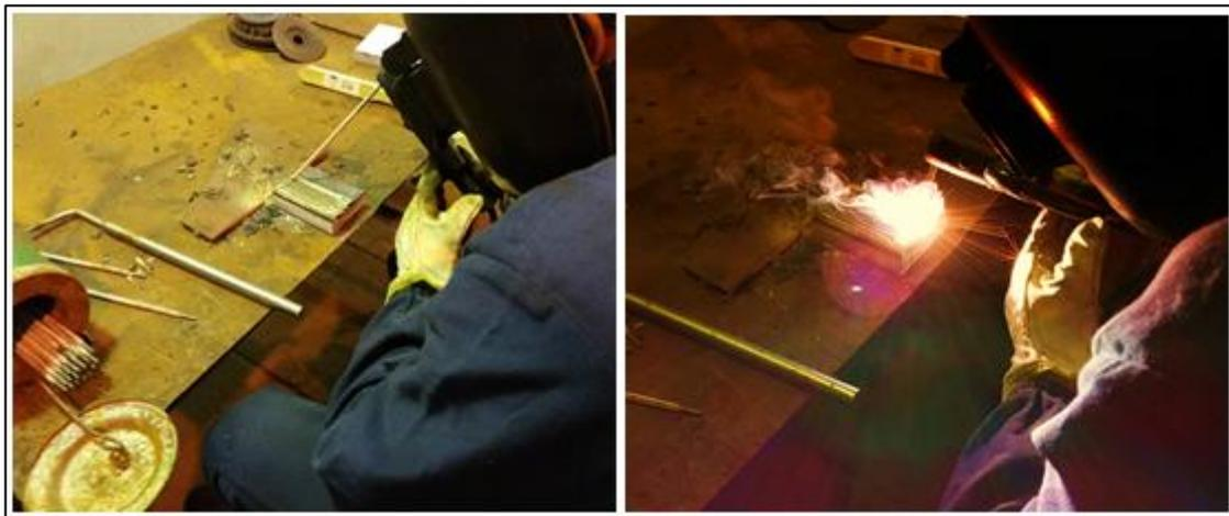
Figura 4.5 – Revestimento das peças com eletrodo revestido
