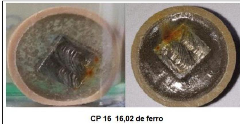
Figura 5.25 – Foto CP 16: corrosão por frestas à temperatura ambiente
