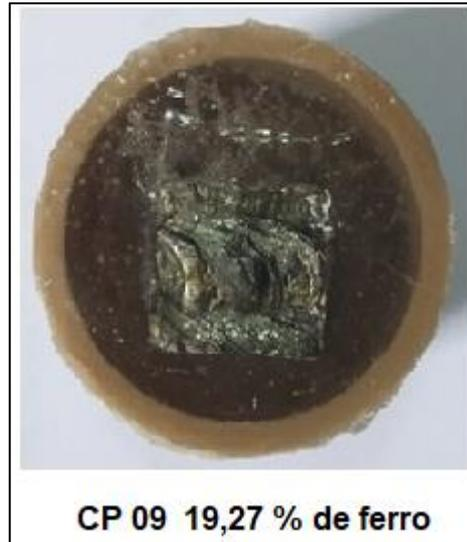
Figura 5.14 – Foto CP 09: corrosão à temperatura ambiente
