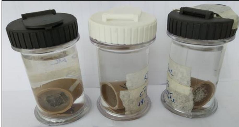
Figura 5.12 – Corpos de prova imersos em solução a 3,5 % em massa de cloreto de sódio
