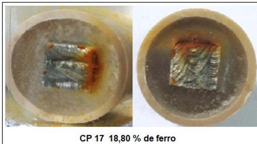
Figura 5.26 – Foto CP 17: corrosão por frestas à temperatura ambiente
