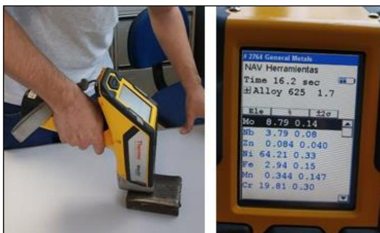
Figura 5.2 – Ensaio de PMI: equipamento portátil NITON XLT 898
