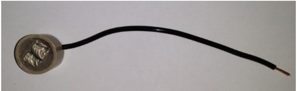
Figura 4.9 – Corpo de prova para ensaio de polarização
