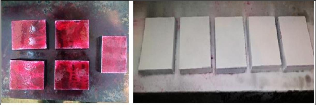
Figura 4.4 – Aplicação do líquido penetrante e o laudo final
