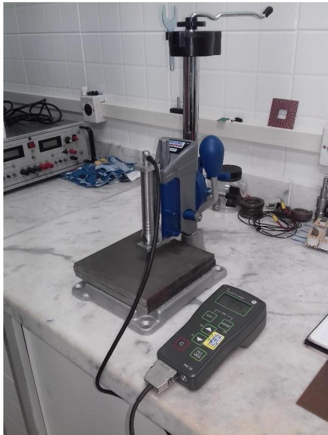
**Figura 41: Durômetro portátil empregado para a caracterização dos materiais de estudo.**
