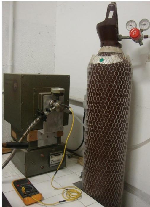
**Figura 36: Forno controlado com atmosfera de gás inerte.**
