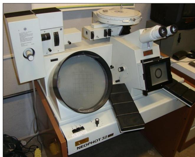
**Figura 44: Microscópio óptico Zeiss Neophot 32 utilizado para o presente estudo.**
