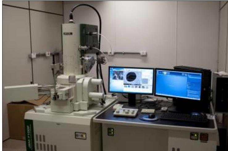
**Figura 45: Microscópio eletrônico de varredura pertencente ao (LaMAR/ CAIPE), do Instituto de Física da UFF.**
