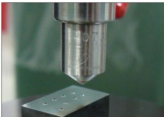
**Figura 39: Amostra ensaiada com 8 endentações em durômetro para HR<sub>B</sub>.**
