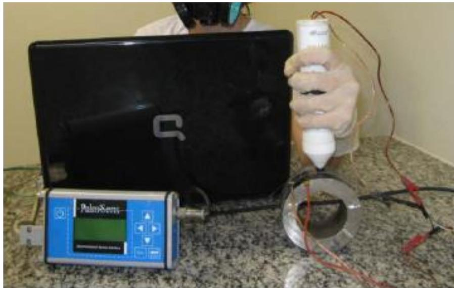
**Figura 31: Célula eletroquímica (HERCULANO, 2004).**
