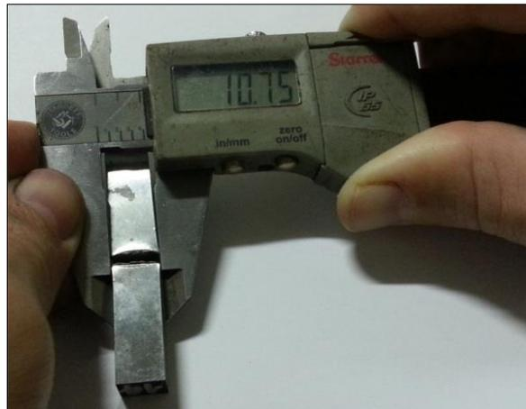
**Figura 43: Medição da expansão lateral de um corpo de prova ensaiado mediante uso de paquímetro.**
