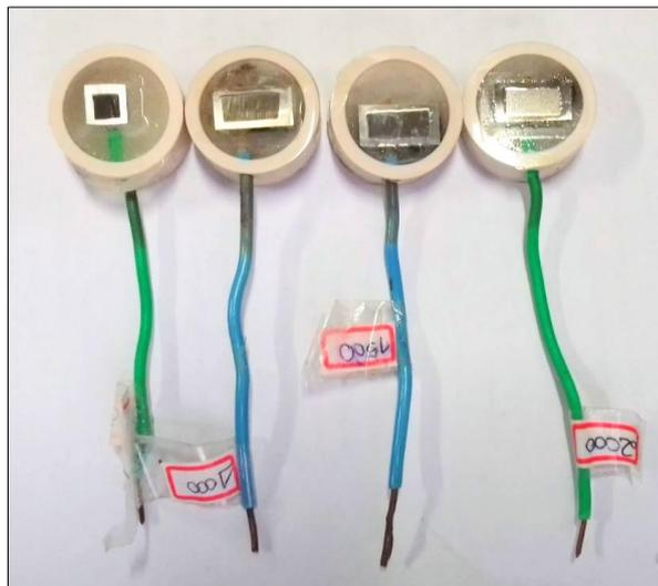
**Figura 47:** Eletrodos de trabalho embutido com resina de cura à frio.
