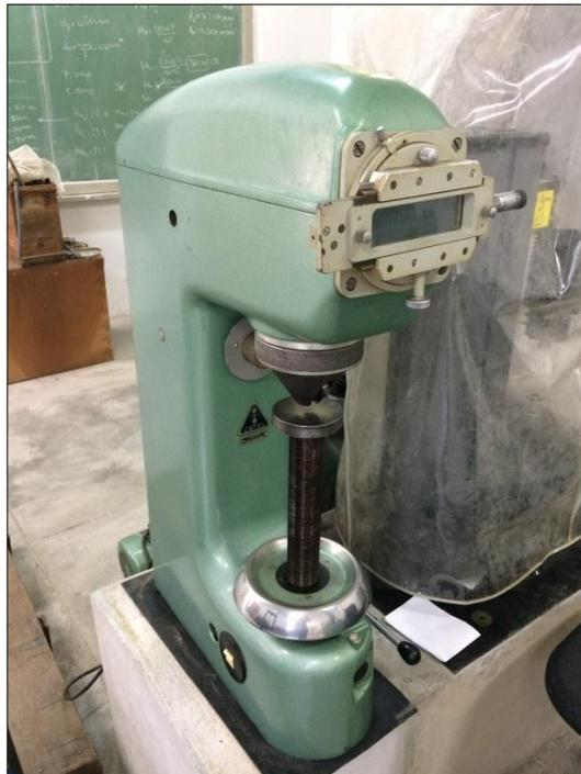
**Figura 40: Durômetro Vickers empregado para a caracterização dos materiais estudados.**
