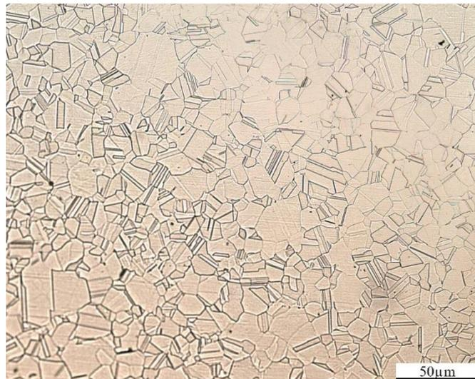
**Figura 2: Micrografia de AISA AL-6XN PLUS (Adaptada de CARDOSO, 2011).**
