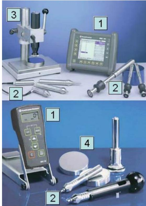
**Figura 21: Acessórios e equipamentos portáteis de ensaios de dureza. (1) Unidade eletrônica de processamento. (2) Sondas de carga. (3) Gabarito para automatização do ensaio. (4) Bloco padrão (FRANK, 2006 *Apud* THIAGO, 2011).**
