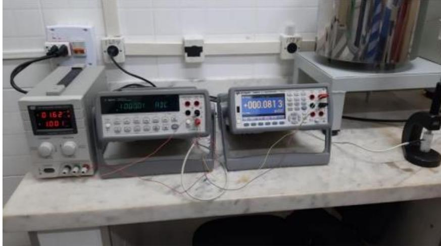
**Figura 49:** Fonte DC, multímetros digitais para medição de diferença de potencial elétrico e corrente elétrica, respectivamente.
