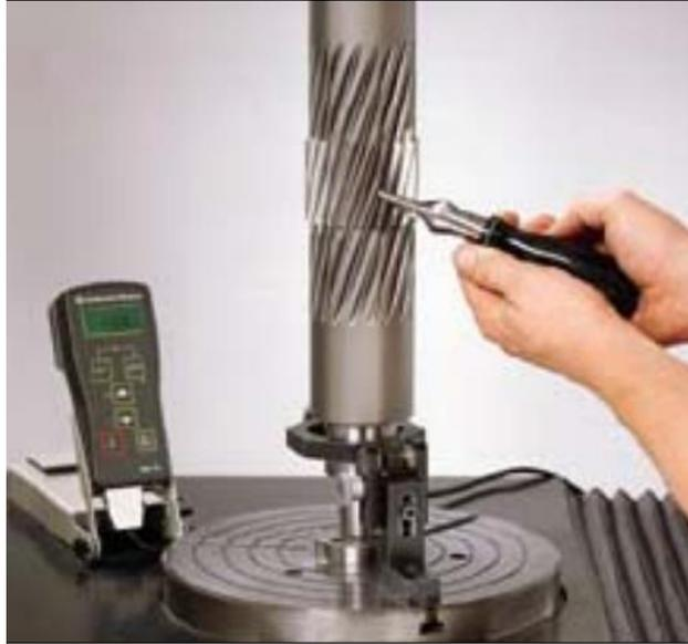
**Figura 19:** Equipamento portátil para ensaio de dureza *UCI* com sonda manual (FRANK, 2006 *Apud* THIAGO, 2011).
