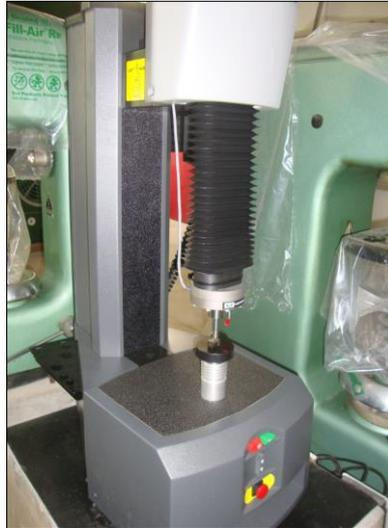
**Figura 38: Durômetro utilizado para obtenção da dureza (HR<sub>B</sub>).**
