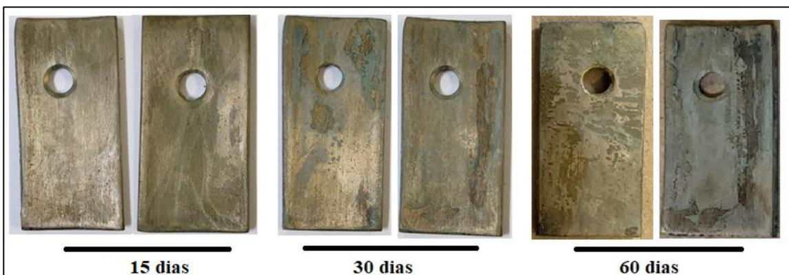
**Figura 40** - Avaliação visual dos corpos de prova em solução salina sintética com adição de 5% do fertilizante
