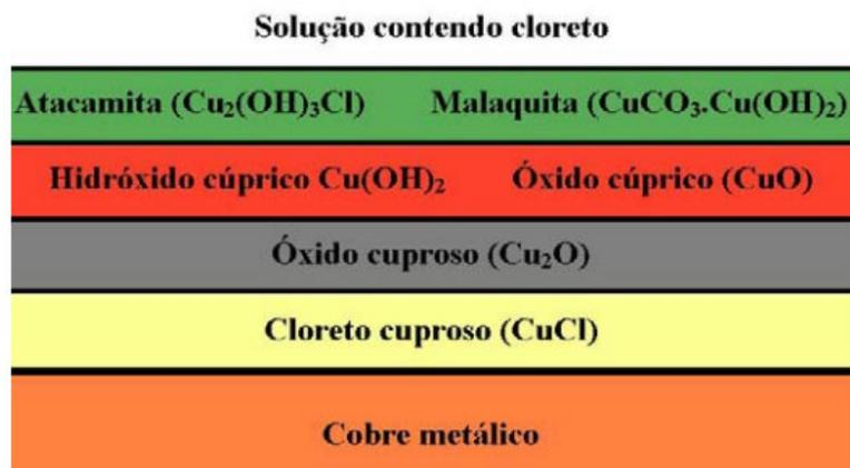
**Figura 10** - Esquema do desenvolvimento dos tipos de produtos de corrosão do cobre em água do mar
