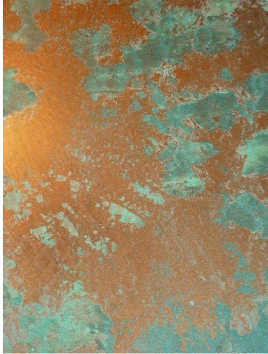
**Figura 14** - Exemplo de corrosão uniforme
