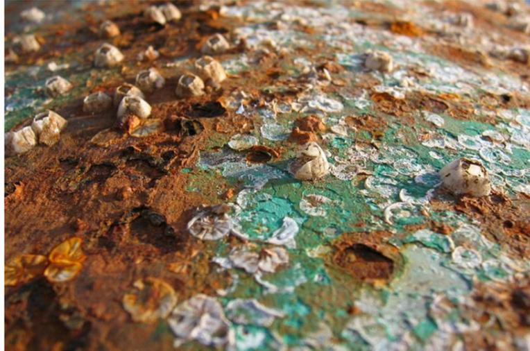
**Figura 16** - Exemplo de corrosão alveolar
