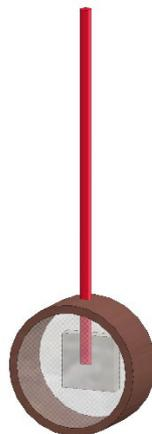
**Figura 33** - Detalhe do embutimento do corpo de prova
