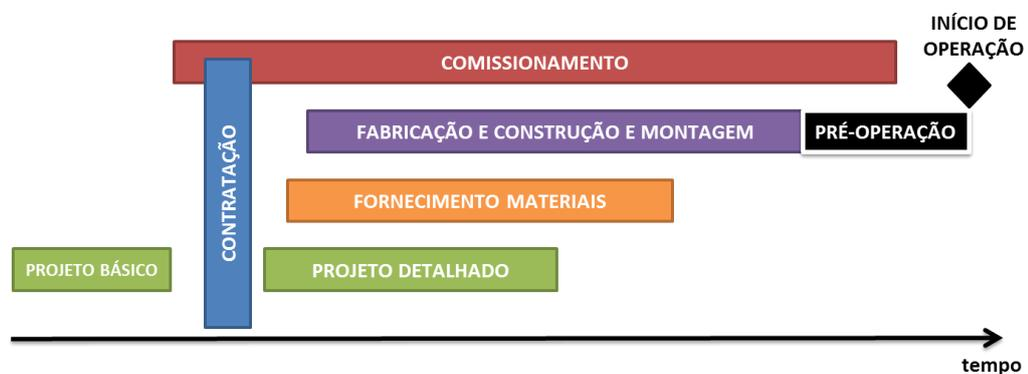
**Figura 3 – Processo de Construção, Montagem e Comissionamento de Obras Industriais.**
