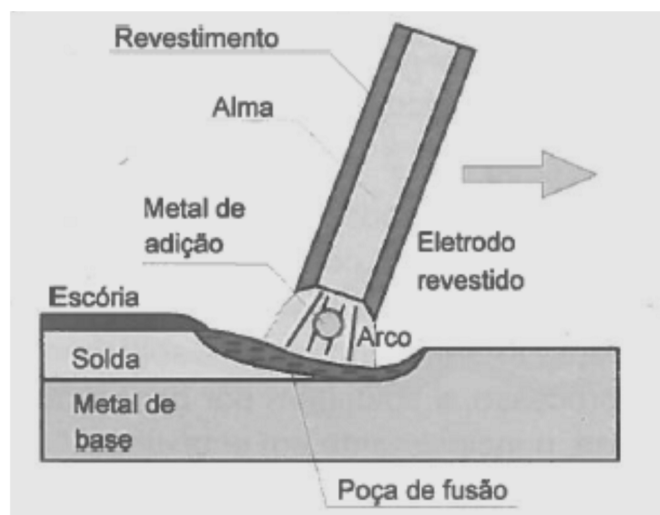
Figura 21: Desenho esquemático de soldagem com eletrodo revestido Fonte: Marques, Modenesi e Bracarense (2007, p. 181)
