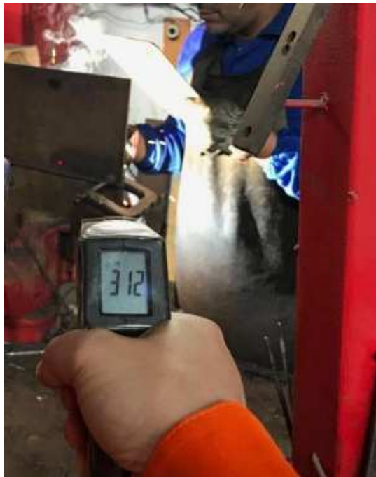
Figura 34: Medição de temperatura de pico durante soldagem Fonte: Elaborado pelo autor (2017)
